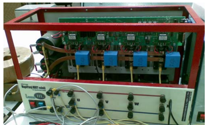
Fig. 4. Realized voltage type PWM rectifier.
