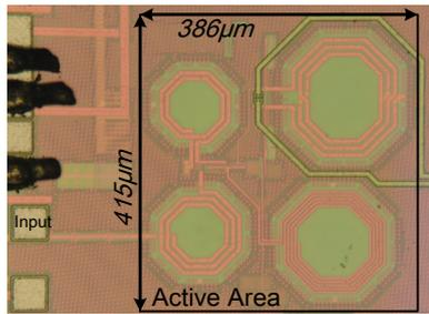
Fig. 10. LNA chip photograph detail.
